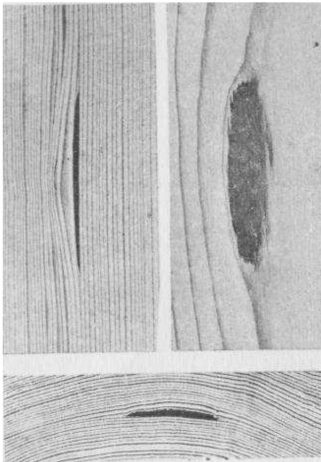
1 - радиальный разрез; 2 - тангентальный разрез; 3 - торцовый разрез
