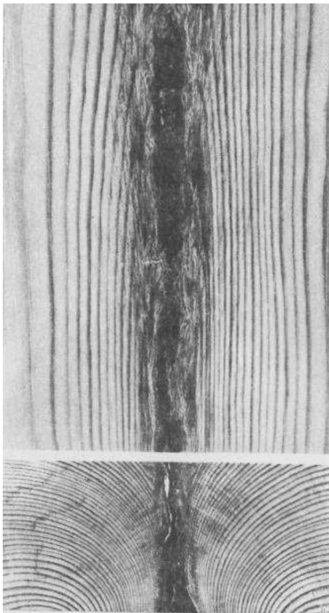
2 - сквозная на тангентальной и торцовой поверхности
